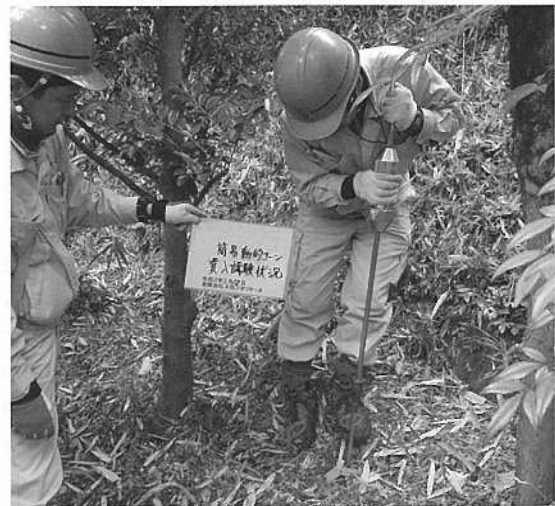
写真-2 簡易動的コーン貫入試験状況
