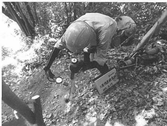
写真-3 土層強度検査棒ベーンコーンせん断試験試験状況
