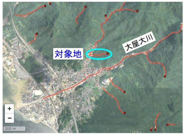
図 5.1.2-10 呉市天応西条 3 丁目 土石流発生箇所（赤線）と調査対象地（水色丸印）位置図※地理院地図引用
