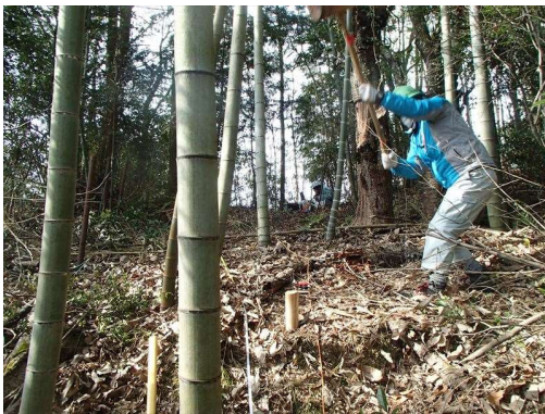
写真-1 屈折法弾性波探査及び表面波探査状況
