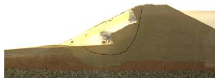
写真 4.3.5 法尻からの進行的なすべり破壊 5)
